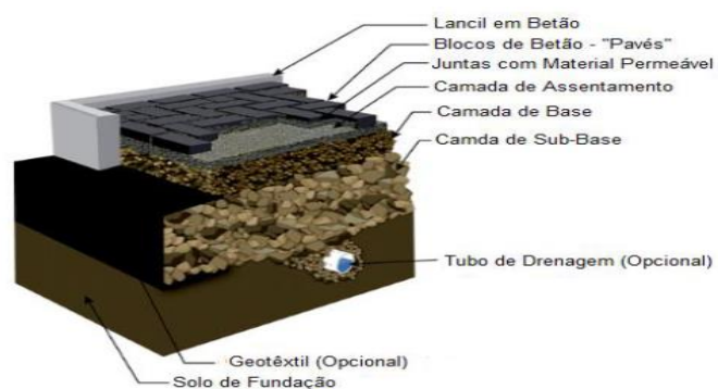
Figura 2 - Corte transversal de um pavimento permeável.
