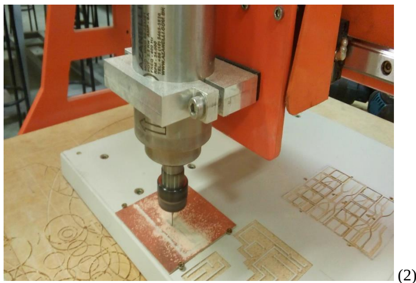
Figura 2 (Placa de fenolite sendo desgastada na CNC)
