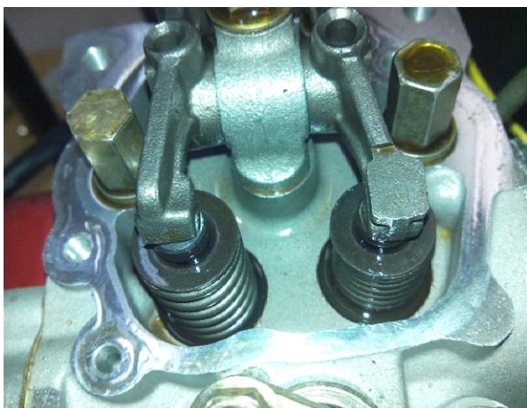
Figura 9. Válvulas do gerador a diesel
