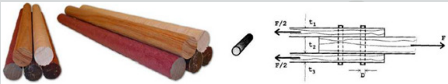
Figura 7. Ligação com cavilhas de madeira. Fonte: Carpintaria.
