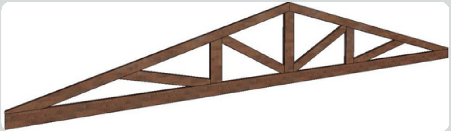
Figura 12: Modelo 3D da treliça em Revit.
